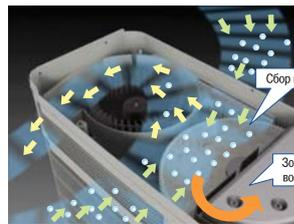
Поступающий в наружный блок атмосферный воздух проходит через кассету из пористого гигроскопичного материала (цеолита). Вращение кассеты приводит к переносу влаги в зону нагрева.
