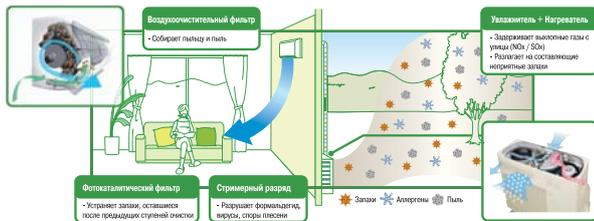
FTXR осуществляет двухстадийную очистку воздуха – в наружном и внутреннем блоках. На первой стадии специальный катализатор разлагает неприятные запахи и удаляет выхлопные газы (NO<sub>x</sub>, SO<sub>x</sub>). Фильтр, расположенный в месте соединения гибкого рукава с внутренним блоком, задерживает пыль и пылинку. Вторая стадия очистки включает фотокаталитический фильтр и источник стримерного разряда.
