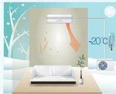
Кондиционер может работать в режиме обогрева при температуре наружного воздуха до  $-20^{\circ}\text{C}$ . Это достигается за счет изменения производительности компрессора, использования электрических подогревателей поддона наружного блока, и применению технологии «теплый старт» (предпусковой подогрев).
