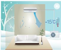
Кондиционер может работать в режиме охлаждения при температуре наружного воздуха до  $-15^{\circ}\text{C}$ . В зависимости от температуры на улице изменяется производительность компрессора и скорость вращения вентилятора наружного блока.
